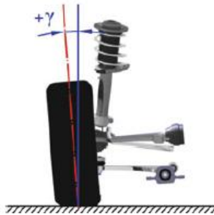
Abbildung 2-8: Sturzwinkel nach ISO 612 [Ers-17a]
