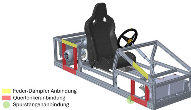
Abbildung 4-28: CAD Modell des Versuchsträgers mit markierten Anbindungsstellen [Bad-24]
