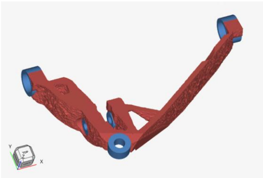
Abbildung B-34: Ergebnis der Topologieoptimierung des oberen Querlenkers der Hinterachse der Fahrzeugkonfiguration Cargo, rot: genutzter Designspace, blau: Non-Designspace [Haw-24]
