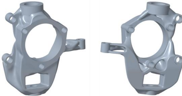
Abbildung 4-36: Finales CAD-Modell des Radträgers, links: radseitige Ansicht, rechts: aufbauseitige Ansicht [Haw-24]
