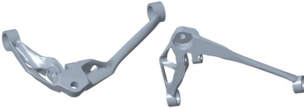
Abbildung 4-39: Finales CAD-Modell des oberen Querlenkers der Hinterachse der Fahrzeugkonfiguration Basis in radseitiger Ansicht, links: von oben, rechts: von unten [Haw-24]
