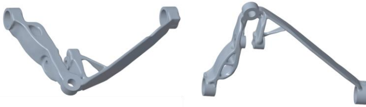
Abbildung B-35: Finales CAD-Modell des oberen Querlenkers der Hinterachse der Fahrzeugkonfiguration Cargo in radseitiger Ansicht, links: von oben, rechts: von unten [Haw-24]
