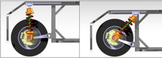
Abbildung 4-5: Hubsystem der Hinterachse, links: Fahrposition, rechts: abgesenkter Zustand [Wei-22]
