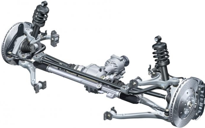
Abbildung 2-15: Ausgeführte Doppelquerlenkerradaufhängung an der Vorderachse eines Audi R8 [Aud-25]
