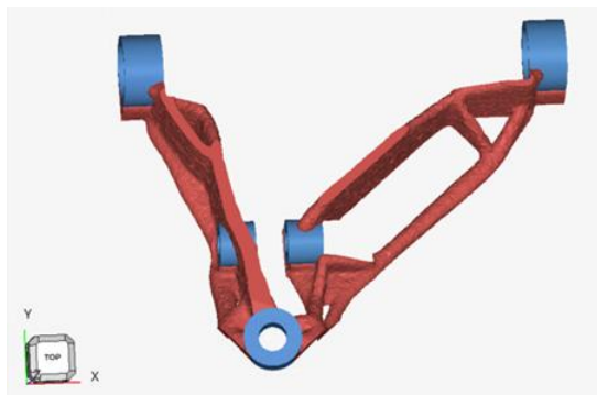
Abbildung 4-41: Ergebnis der Topologieoptimierung des oberen Querlenkers der Vorderachse der Fahrzeugkonfiguration Basis, rot: genutzter Designspace, blau: Non-Designspace [Haw-24]
