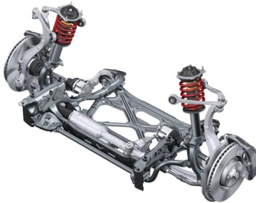
Abbildung 2-27: Ausgeführte Mehrlenkerradaufhängung am Beispiel einer Fünflenker-Vorderachse des Audi A6 [Aud-25]
