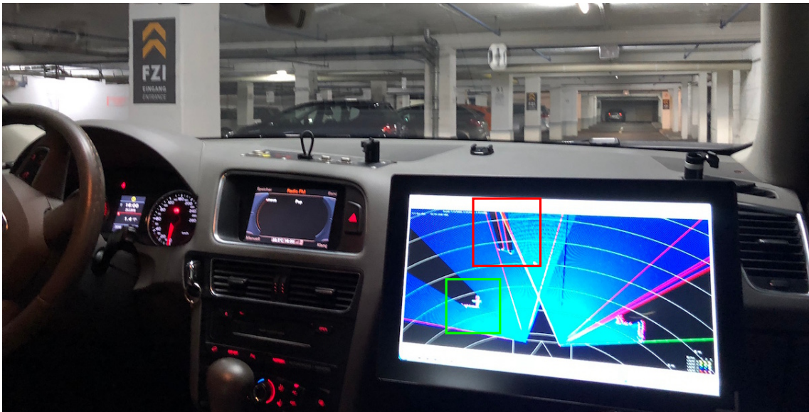
(c) Darstellung der augmentierten Laserscandaten im Frontend des Fusionssteuergeräts innerhalb des Experimentalfahrzeugs CoCar mit realer Säule (grün) und virtuellem Fußgänger (rot).
