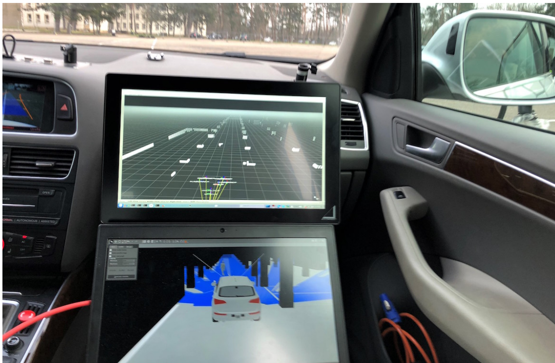
(a) Funktionsweise: Die reale Position des Versuchsträgers wird in den Avatar innerhalb des digitalen Abbilds gespeist und die virtuellen Sensordaten werden in das Steuergerät im Versuchsträger injiziert. Ausschnitt aus Originaldarstellung [Zofka et al., 2018a].
