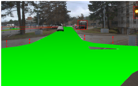
(a) Modellfehler durch Straßenmodell und Positionierungsübergabe. Pfeile und gestricheltes Dreieck zeigen lateralen Versatz der hinter Containern liegenden Straßenführung auf.
