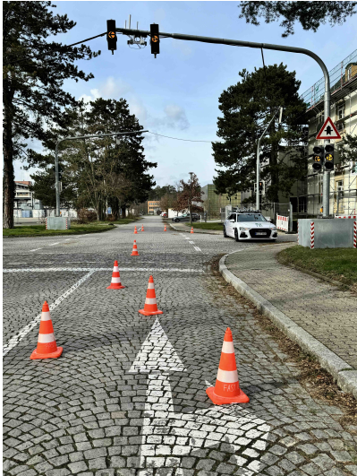
(a) Fahrbahn mit Pylonen als Kalibriermuster.
