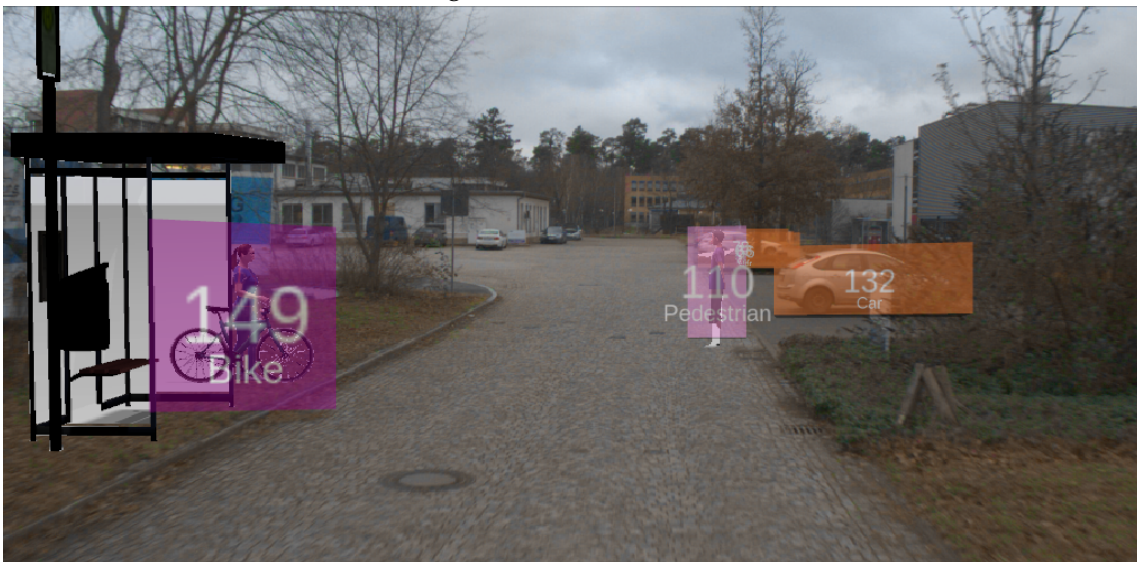
(b) Virtuelles Fahrrad, virtueller Fußgänger und reales Fahrzeug werden erkannt, trotz durch nicht-modellierte Transparenz und Segmentierungskamera induzierten Modellfehler.
