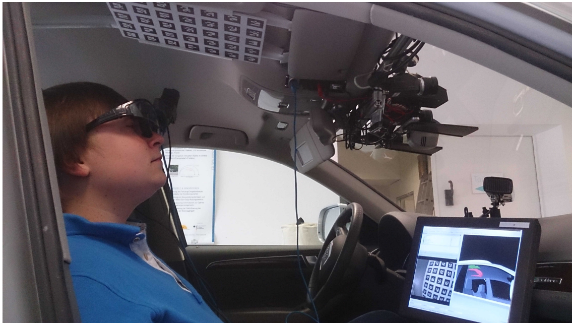
(a) Referenzmarkerfläche am Fahrzeughimmel.
