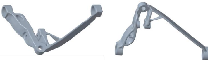
Abbildung B-35: Finales CAD-Modell des oberen Querlenkers der Hinterachse der Fahrzeugkonfiguration Cargo in radseitiger Ansicht, links: von oben, rechts: von unten [Haw-24]
