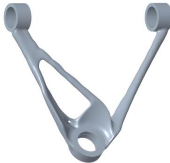
Abbildung B-39: Finales CAD-Modell des unteren Querlenkers der Fahrzeugkonfiguration Cargo [Haw-24]
