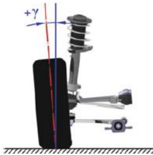
Abbildung 2-8: Sturzwinkel nach ISO 612 [Ers-17a]
