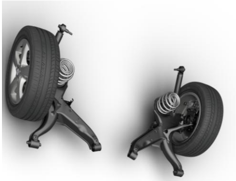
Abbildung 2-23: Ausgeführte Schräglenkerradaufhängung an der Hinterachse des Mercedes-Benz Vito [Mer-14]
