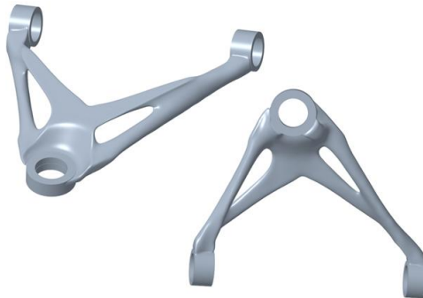
Abbildung B-20: Finales CAD-Modell des unteren Querlenkers der Fahrzeugkonfiguration Komfort, links: radseitige Ansicht von oben, rechts: aufbauseitige Ansicht von unten [Bad-24]
