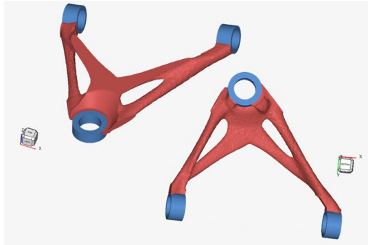
Abbildung B-19: Ergebnis der Topologieoptimierung des unteren Querlenkers der Fahrzeugkonfiguration Komfort, links: radseitige Ansicht von oben, rechts: aufbauseitige Ansicht von unten; rot: genutzter Designspace, blau: Non-Designspace [Bad-24]
