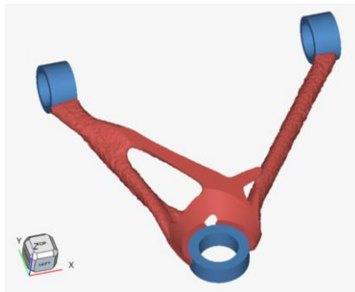
Abbildung 4-44: Ergebnis der Topologieoptimierung des unteren Querlenkers der Fahrzeugkonfiguration Basis, rot: genutzter Designspace, blau: Non-Designspace [Haw-24]
