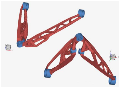
Abbildung B-22: Ergebnis der Topologieoptimierung des oberen Querlenkers der Fahrzeugkonfiguration Rallye, links: radseitige Ansicht von oben, rechts: aufbauseitige Ansicht von unten; rot: genutzter Designspace, blau: Non-Designspace [Bad-24]
