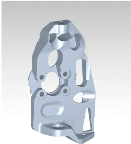
Abbildung B-6: Ergebnis der Topologieoptimierung des Radträgers, rot: genutzter Designspace, blau: Non-Designspace
