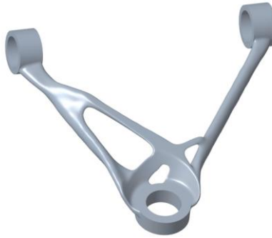
Abbildung 4-45: Finales CAD-Modell des unteren Querlenkers der Fahrzeugkonfiguration Basis in radseitiger Ansicht von oben [Haw-24]
