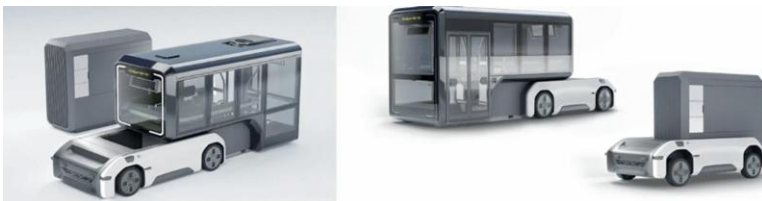
Abbildung 5-32: Driveboard mit Kapseln [Mün-22]
