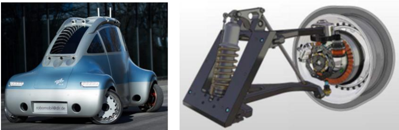
Abbildung 5-27: Robomobil, links: Fahrzeug, rechts: Radaufhängung [DLR-14]
