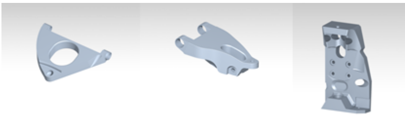
Abbildung B-1: Designspace der einzelnen Komponenten, links: oberer Querlenker, Mitte: unterer Querlenker, rechts Radträger
