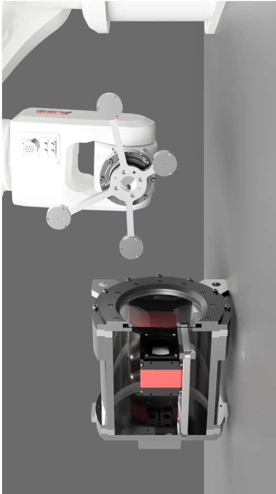
Abbildung B.4: Schnittbild eines MAPS-Prototyps und Ansicht auf das Roboter-Target.
