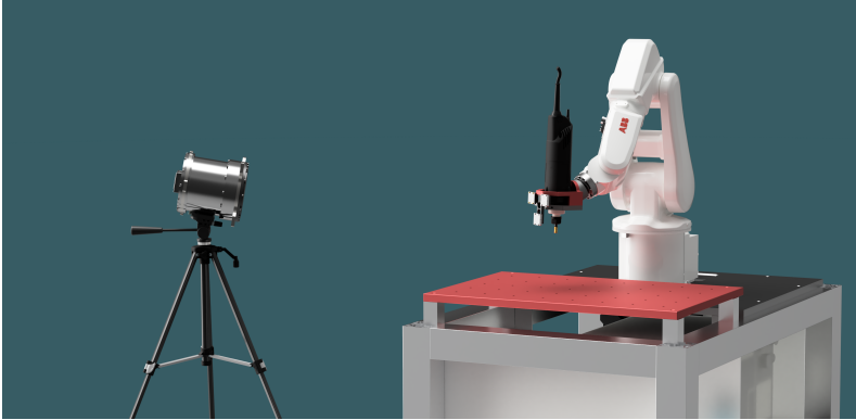
Abbildung 1.1: Gerendertes Bild einer Roboter-Bearbeitungszelle (rechts) mit Werkzeug und Target. Als externes Messgerät dient MAPS (links).
