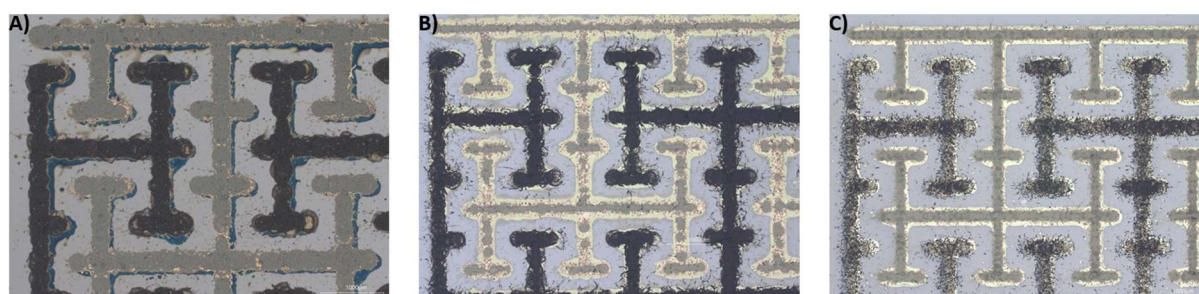
Abbildung 37: Druckverhalten verschiedener Si-Tinten (grau) und MnO 2 -Tinten (schwarz) bei Konzentrationen von A) 10,17 wt%, B) 12,60 wt% und C) 14,83 wt%
