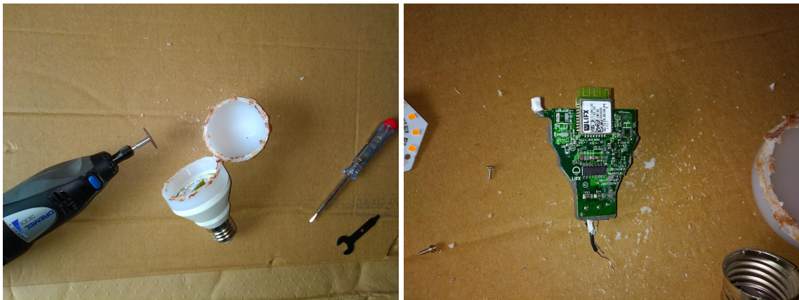
Abbildung 4.2: Eine demontierte LIFX Mini smarte Glühbirne.
