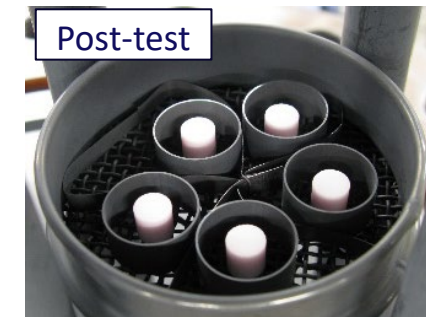
Eu 2 O 3 -50 mol% ZrO 2 sintered pellets
