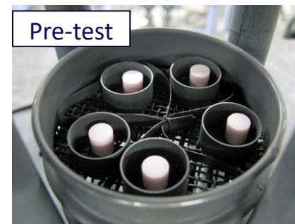
Eu 2 O 3 -50 mol% ZrO 2 sintered pellets
