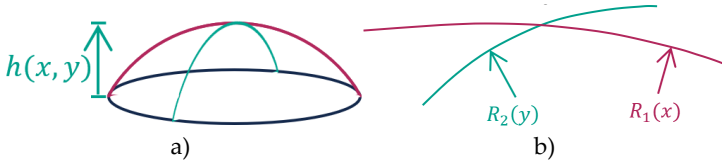
Abbildung 2.1: a) Schematische Darstellung eines 3D-Tropfens mit Schnittebenen und eingezeichneter Höhe h(x, y) . b) Hauptkrümmungsradien an der Oberfläche eines 3D-Tropfens.
