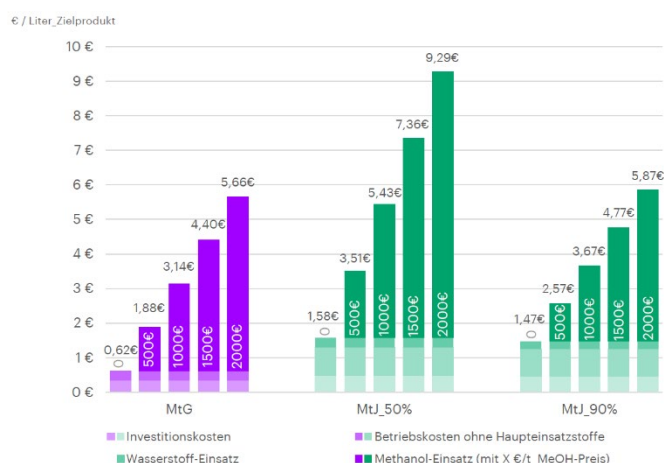
Abbildung 6.9: Auswirkung einer Variation des Methanolpreises auf die Produktkosten. Betrachtet wurde eine Anlagenkapazität von 200 kt/a.
