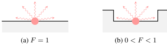
Abbildung 3.3: Abgabe von Wärmestrahlung von der Oberfläche eines Körpers an die Umgebung mit unterschiedlichen Sichtfaktoren F .
