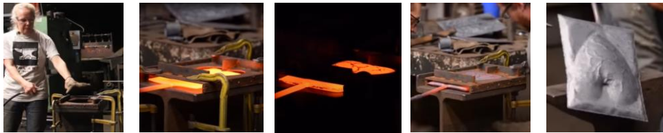
Abbildung 2.17: Verknüpfung »Semi-Die-Less-Hydroforming« und »Hot-Die-Less-Hydroforming« am Beispiel eines Kunstobjektes von »Elizabeth Brim« {Bildquelle: Aufnahmen erstellt & zugeschnitten durch Verf. aus: https://youtu.be/mZKdXuGfjMI , Videokanal von »PenlandSchool«}
