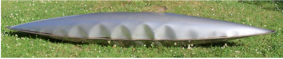
Abbildung 3.15: Probekörper »WA1« mit charakteristischem Beulmuster {Bildquelle: »KIT-VAKA«}
