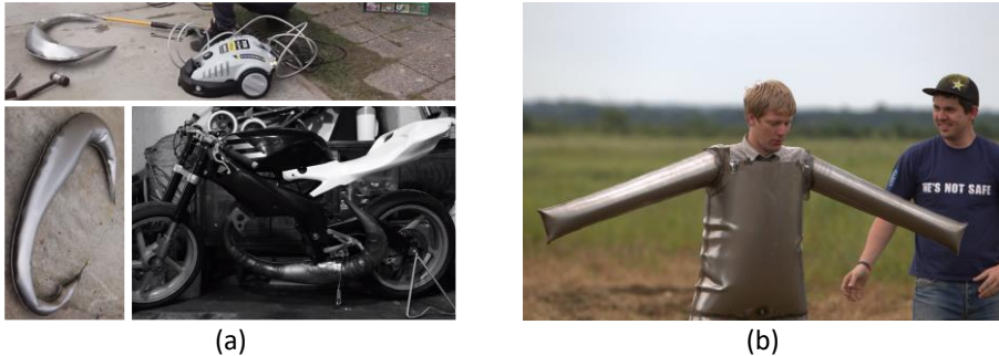
Abbildung 1.6: Anwendungsbeispiele für »Die-Less-Hydroforming« aus dem Hobbybereich: (a) Herstellung einer maßgefertigten Auspuffanlage {Bildquelle: Aufnahmen erstellt & zugeschnitten durch Verf. aus: https://youtu.be/ppXRMTer2NQ , Videokanal von »PROTORS500KTM«}; (b) »Fire-work Safety Suite« von Colin Furze {Bildquelle: [12]}
