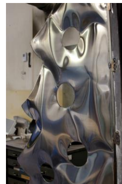
Abbildung 2.6: »Die-Less-Hydroforming«-Weihnachtsbaum der Versuchsanstalt für Stahl, Holz und Steine
