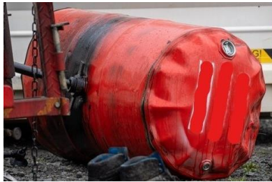
Abbildung 3.3: Beul- und Faltenbildung am ebenen Deckel eines Stahl-Fasses bei Innendruck {Bildquelle: [51], Bildzuschnitt und Bildanonymisierung durch Verf.}
