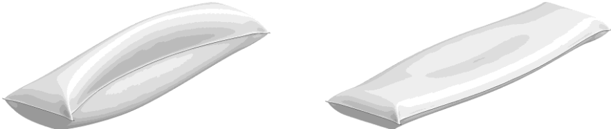
Abbildung 7.25: Arten von Eigenformen bei einer »Begleitenden Eigenwert-Beulanalyse« mit der Platine L2000/B400/t2 an verschiedenen Simulationsschritten
