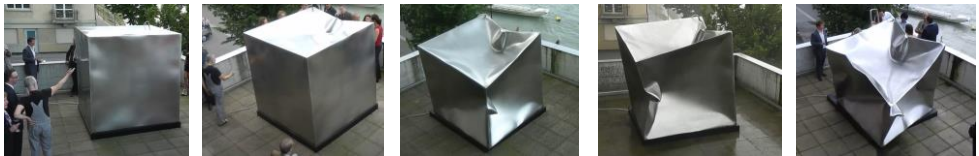
Abbildung 2.16: Ablauf der Umformung beim »3D-Die-Less-Hydroforming« mit Unterdruck am Beispiel des Kunstobjektes »IMPOLODED CUBE (Triple B)« von »Ewerdt Hilgemann«, entstanden durch Unterdruck-Umformung eines Würfels mit 2 m Kantenlänge bei der Galerie »Marc de Puechredon« in Basel in 2013 {Bildquelle: Aufnahme erstellt & zugeschnitten durch Verf. aus: https://youtu.be/BcGE9cU-gLA , Videokanal von »Franz Bannwart«}
