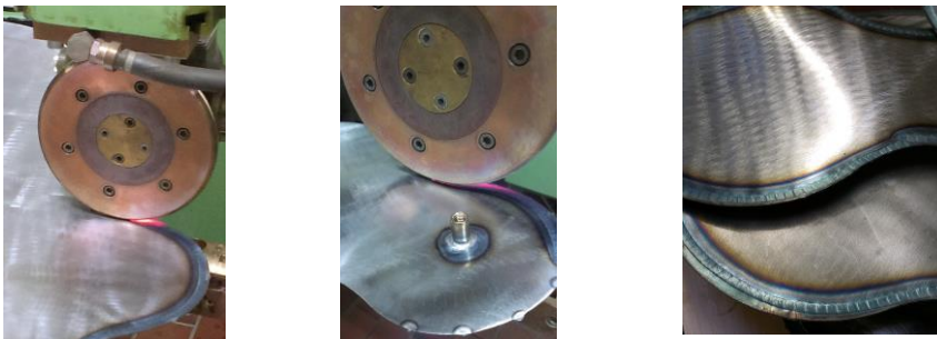
Abbildung 2.19: Schweißen einer »Die-Less-Hydroforming«-Füge- und Dichtnaht als Überlappnaht durch »Rollennahtschweißen«
