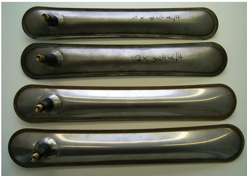
Abbildung 2.20: »Die-Less-Hydroforming«-Probekörper (Länge ca. 300 mm) des »KIT-VAKA« geschweißt durch die »SLV Mannheim« mit Überlappnaht per Laserstrahlschweißen
