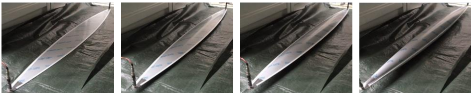
Abbildung 3.16: Umformsequenz einer doppelagigen »Die-Less-Hydroforming«-Platine ohne das Auftreten von Beul- und Faltenerscheinungen [15] {Bildquelle: Produktflyer »Hybridstütze Perfecto«, 2019, »KIT-VAKA«, Bildzuschnitt durch Verf.}
