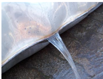
Abbildung 3.14: Versagen durch Aufreißen an der Schweißnaht {Bildquelle: »KIT-VAKA«}
