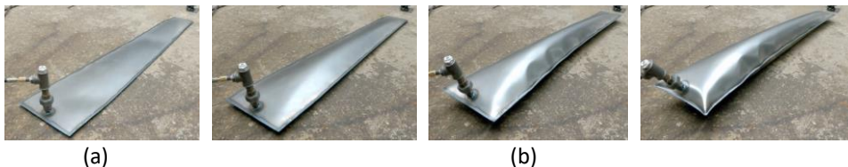
Abbildung 3.6: Umformsequenz einer streifenförmigen doppellagigen »Die-Less-Hydroforming«-Platine mit rechteckiger Form: (a) Ausgangszustand mit leichtem Schweißverzug; (b) Eintreten des charakteristischen Beulmusters an den Platinenlängsrändern {Bildquelle: Aufnahmen erstellt & zugeschnitten durch Verf. aus: https://youtu.be/eA46WFX7jWA , Videokanal von »colinfurze«, Bilddarstellung und Bildbeschreibung in Anlehnung an [59]}
