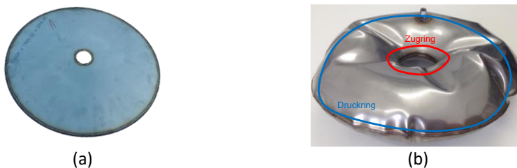
Abbildung 3.9: »Die-Less-Hydroforming«-Kreisring-Probekörper aus [31]: (a) Ausgangszustand; (b) Zustand nach Innendruck-Umformung mit Beul- bzw. Faltenerscheinungen {Bildquelle: »KIT-VAKA«}
