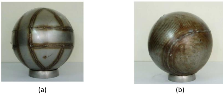
Abbildung 2.15: »Integral Hydro-Bulge Forming (IHBF)« mit an den Aufbau der Hülle von Sportbällen angelehnten Hohlkörpern, bei welchen bereits im Ausgangszustand gekrümmte Bleche zum Fügen des Hohlkörpers verwendet werden: (a) Volleyball; (b) Tennisball {Bildquelle: [27]}
