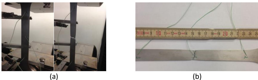
Abbildung 5.2: Zugversuch nach DIN EN ISO 6892-1:2017-02 [80] mit Temperaturmessung zur Bestimmung des Fließbeginns in Anlehnung an die Methodik nach [88] {Bildquelle: »KIT-VAKA«}
