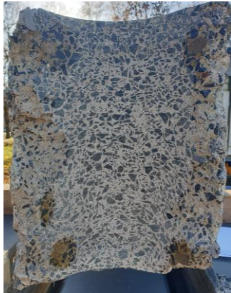
a) Schnittstelle durch Kernbohren
