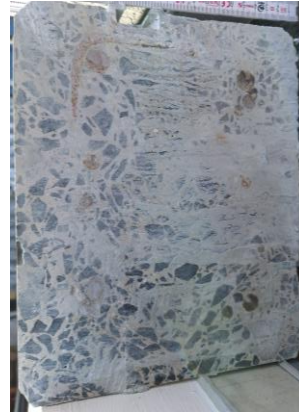
b) Schnittstelle durch Sägen
