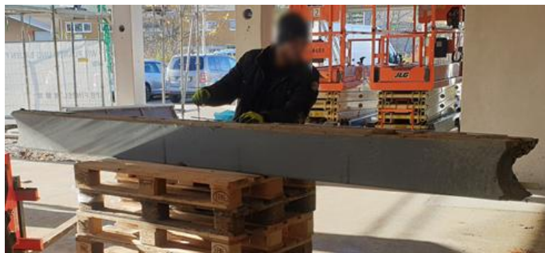
Anhang A1 6-1: Entnommenes Bauteil in der Sichtprüfung [Foto Stöhr]
