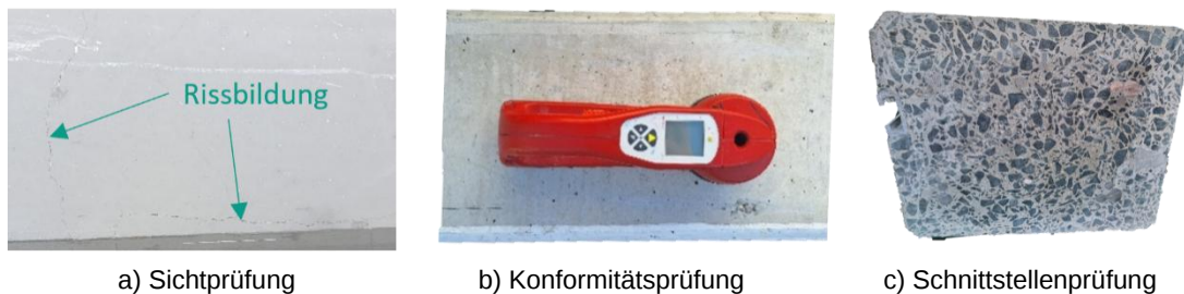
Abbildung 6-5: Grundlagenermittlung zur Integritätsbewertung am einzelnen rückgebauten Modul
