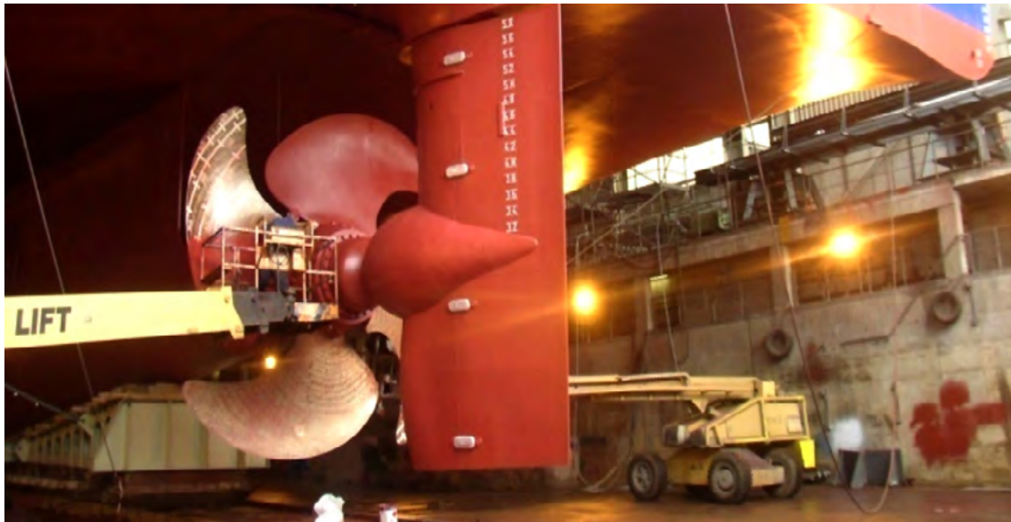
Abbildung 4.3 Twistiertes Ruder mit integrierter Propulsionsbirne
