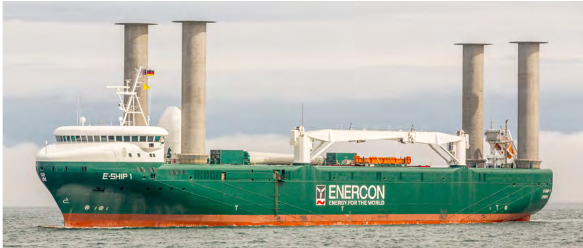
Abbildung 4.4 Frachtschiff mit vier Rotorsegeln
