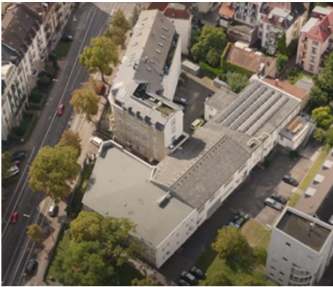
Abbildung A.7.: PV-Anlage von NAP 1 mit 5 kWp und südlicher Ausrichtung. Entnommen aus einer Drohnenaufnahme des Reallabors Smart East [193].
