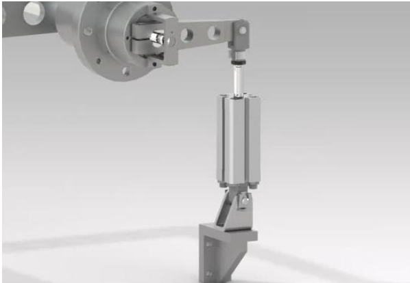
Abbildung 6-7: Vereinfachte Darstellung eines Pneumatikzylinders (in Anlehnung an (Ilchmann et al. 2006))
