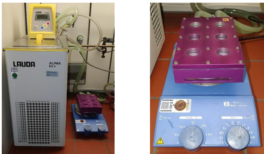
Abbildung 83: Belichtungsaufbau mit Thermostat, Kühlung und Lichtquelle.
