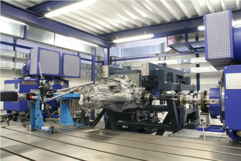
Abbildung 2.14: Powertrain-in-the-Loop-Prüfstand (Institut für Produktentwicklung [IPEK], 2025). Dreimotoren-Prüfstand mit hochdynamischer Antriebsmaschine zur physikalischen Untersuchung kompletter Antriebsstränge. Der Prüfstand ermöglicht die Echtzeitsimulation des virtuellen Restsystems zur Nachbildung realer Betriebsbedingungen.
