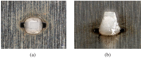
Abbildung A.3: Mikroskopaufnahme der gefertigten DRA: (a) Draufsicht, (b) Seitenansicht, [13] © 2023 IEEE.
