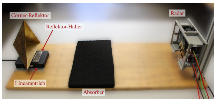
Abbildung 6.24: Messaufbau zur Entfernungsmessung eines mittels Linearantriebes bewegten Corner-Reflektors als Radarziel.
