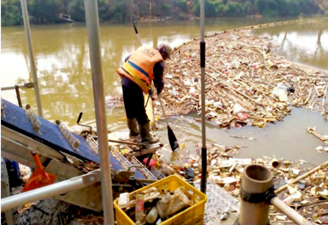
Abbildung 5.5 Einsatz einer schwimmenden festinstallierten Barriere in Kombination mit einem Müllsammelbot mit semipassivem Förderband in Jakarta
