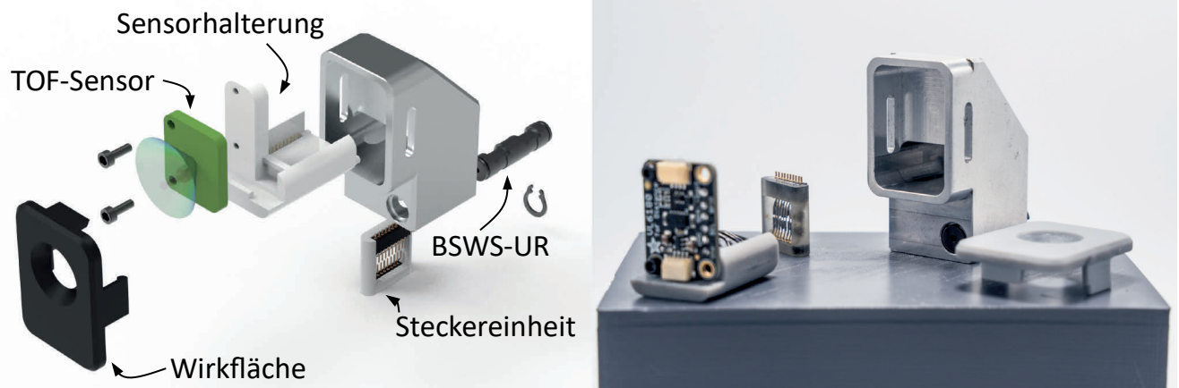
Abbildung 8-33: Explosionsansicht der Fingerspitze mit Distanzsensorik
