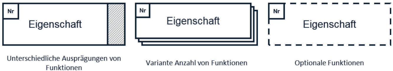
Abbildung 2-14: Systematik zur Abbildung der Varianz von Teilfunktionen (eigene und veränderte Darstellung nach (A_Meschter, 2021, S. 46))
