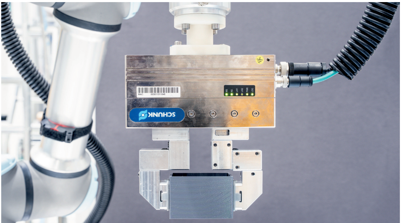
Abbildung 8-40: Handhabungsversuch mit der in der Konfiguration ermittelten besten Konfiguration für das Handhabungsobjekt „Hohlteil_3“
