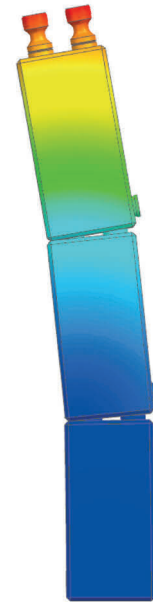
b) Aufbiegung gegen die Greifrichtung
