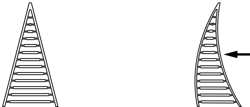
Abbildung 2-2: Der Fin Ray Effect® zeigt sich bei Einwirkung einer Kraft auf die abgebildete Struktur, indem sich die Seiten der Struktur verbiegen, wodurch sich die Basis und die Spitze in entgegengesetzter Richtung zur Kräfteinwirkung verformen.
