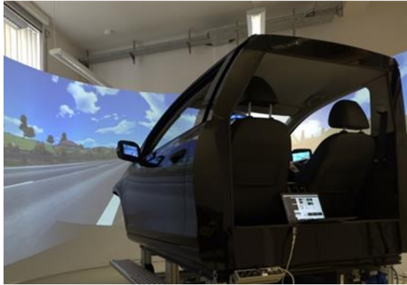
Abbildung 8.6: Offene Rückseite der Fahrzeugkabine im Fahrsimulator (Petersen, Düser & Albers, 2023)
