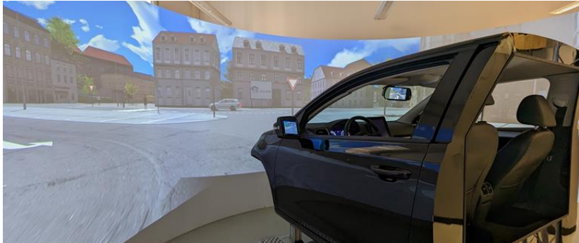
Abbildung 8.1: Fahrsimulator-Setup am Institut für Arbeitswissenschaft und Betriebsorganisation (ifab) am KIT (Petersen, Deml & Albers, 2024)
