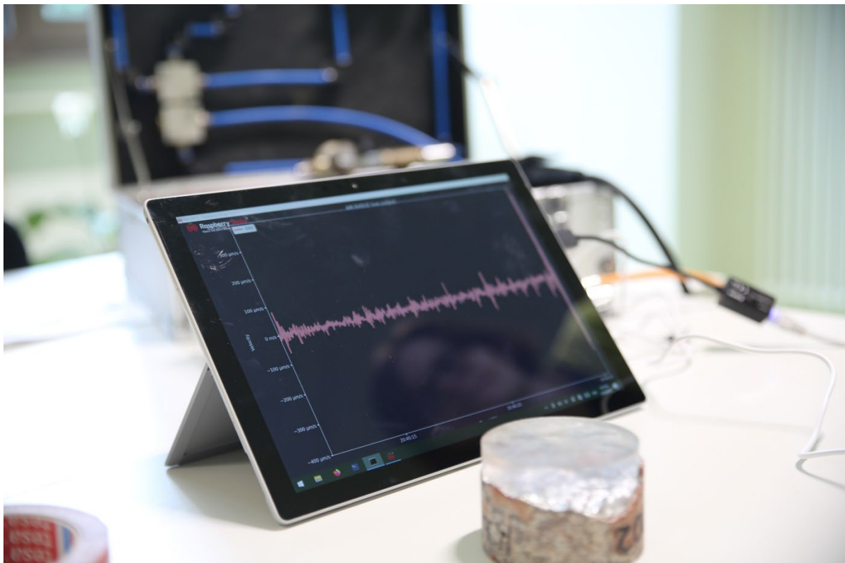
Abbildung 2: Lernstation mit Experimentierkoffer, Raspberry Shake und Visualisierung der Messwerte von Bodenerschütterungen sowie Bohrkern mit Kluft. Foto: Jens Arnold, Daimler Truck AG
