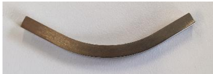
Abb. 5-11: Verbogene, nicht gebrochene Vier-Punkt-Biegeprobe nach Test bei erhöhter Temperatur (200 °C, 300 °C, 400 °C)
