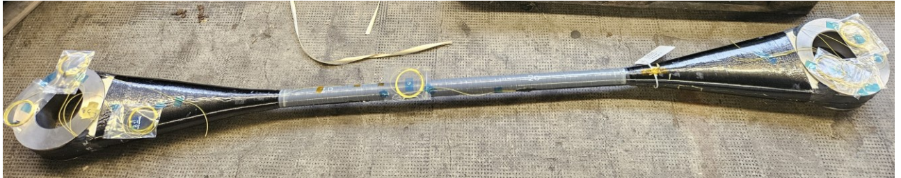
Abbildung 3-45 Probekörper mit integrierten faseroptischen Sensoren, TU Berlin [L224].
