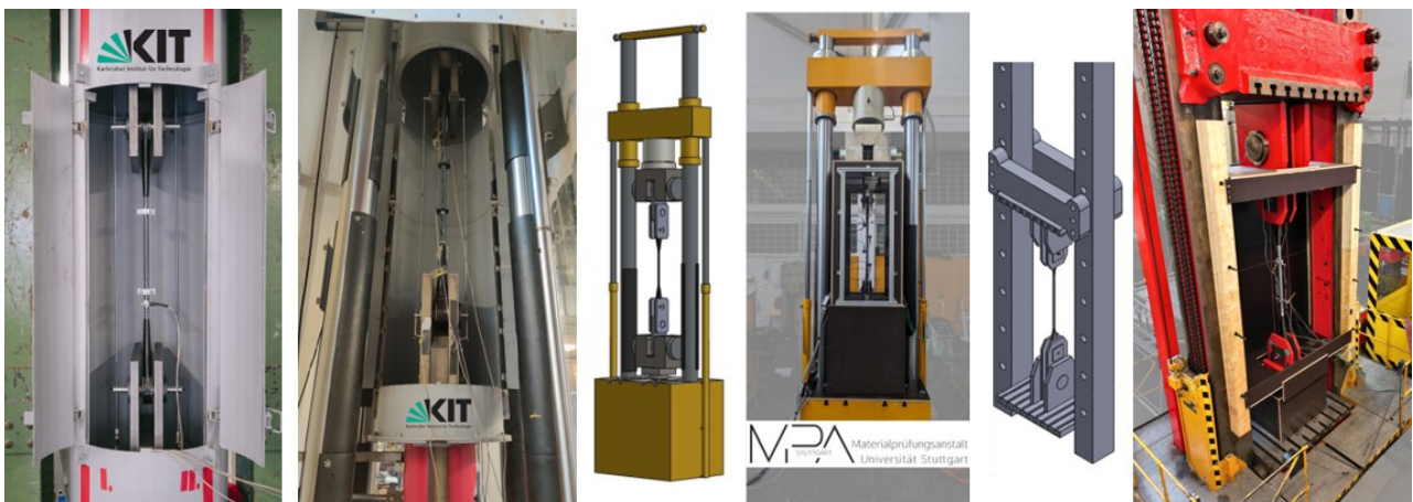
Abbildung 3-5 Stehende Anordnung in Universalprüfmaschinen; von links nach rechts: Prüfmaschine M12 und Prüfmaschine M14 des KIT Karlsruhe, Prüfmaschinen Schenck und Amsler der MPA Stuttgart [L224].
