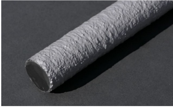
Abbildung 6-15 Beschichtung mit keramischen Partikeln als Vandalismusschutz gegen einfache Klingenwerkzeuge am Beispiel der Stadtbahnbrücke Stuttgart [L74].
