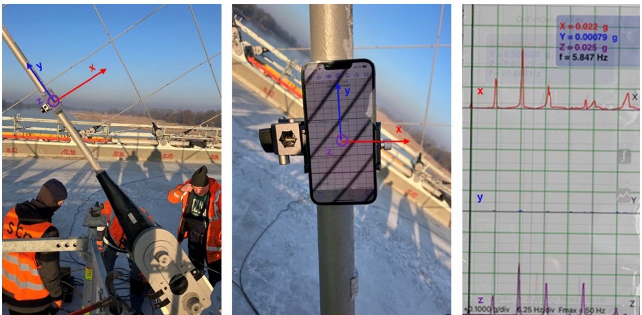
Abbildung 6-10 Messung des Frequenzspektrums mit dem Mobiltelefon an der Oderbrücke Küstrin [L86].
