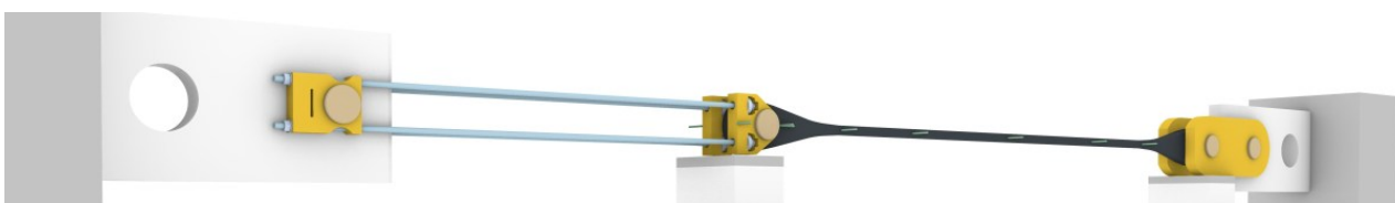
Abbildung 3-17 Prinzipieller Versuchsaufbau zur Bestimmung der Biegesteifigkeit in der Verankerung [L82].
