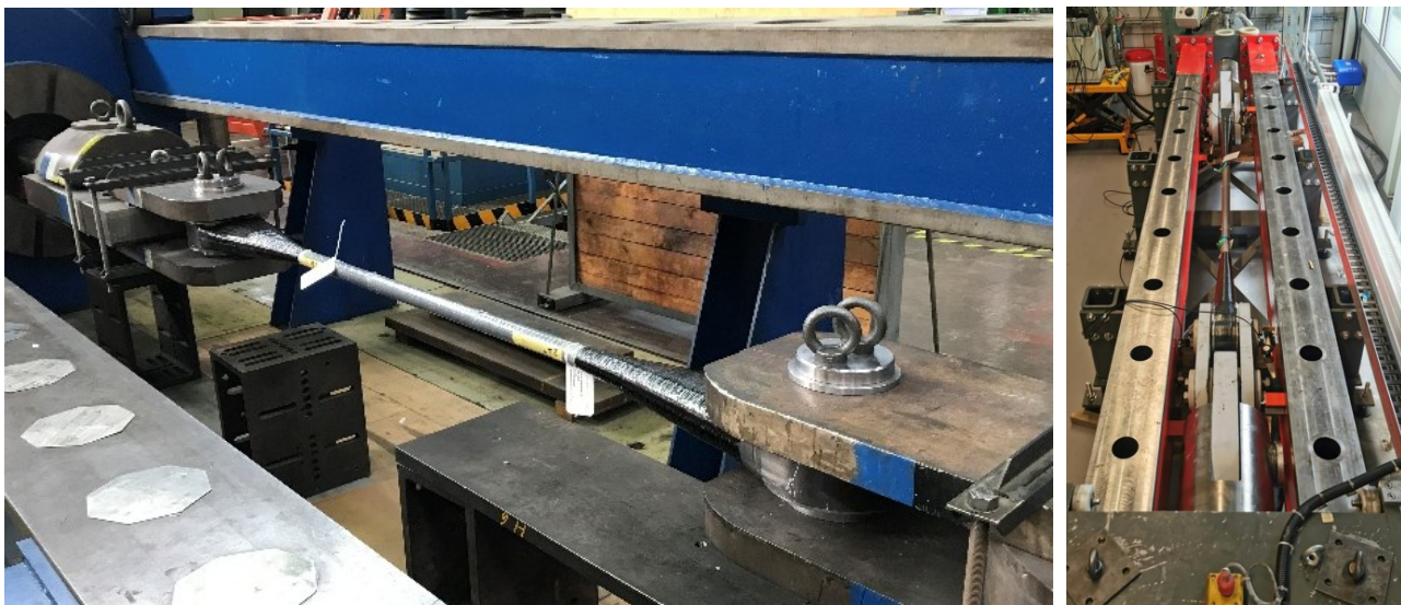
Abbildung 3-4 Liegende Anordnung in Zugprüfmaschine, links: an der MPA Stuttgart [L171], rechts: bei der Firma Carbo-Link [L196]
