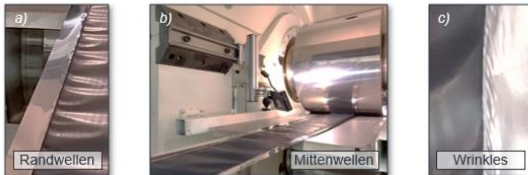
Abbildung 2-6: Ausgewählte geometrische Fehlerbilder nach der Kalandrierung in Anlehnung an (Günther & Schreiner et al. 2019)
