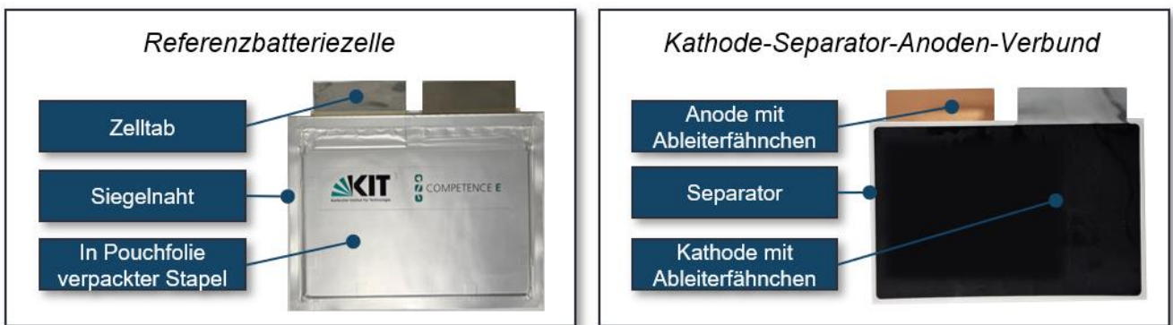
Abbildung 4-2: Als Referenz verwendete Batteriezelle des Batterietechnikums (BATEC) des Karlsruher Instituts für Technologie
