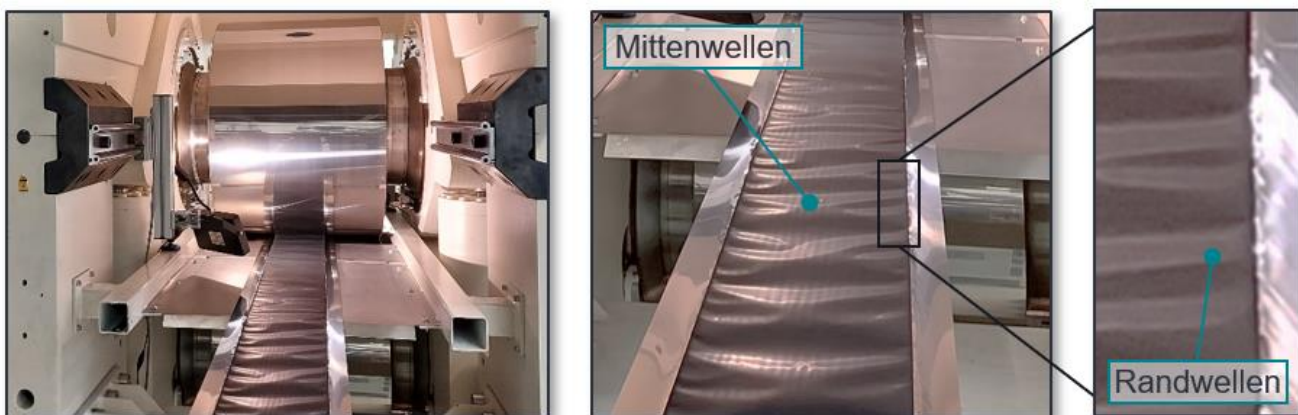
Abbildung 5-10: Untersuchte Effekte bei der Kalandrierung der NMC-Kathoden
