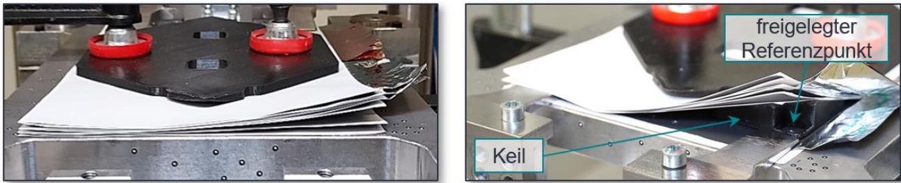
Abbildung 6-28: Auffächern des Stapels ohne Niederhalter und ohne Keil (links) und Fixierung der Lage mittels Niederhalter und eingeschobenen Keil während der Messaufnahme (rechts)
