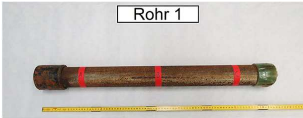
Abbildung 7-1: Rohr 1 mit den untersuchten Bereichen (rot)
