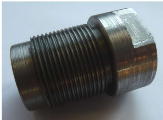
Abbildung 7-10: Gefertigte Verschlusskappe des neuen Werkzeugträgers
