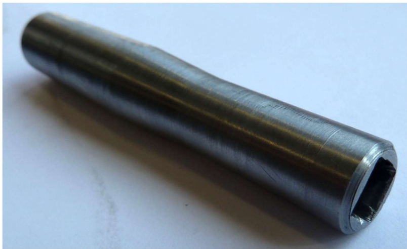
Abbildung 7-11: Gefertigter Wellenadapter des neuen Werkzeugträgers
