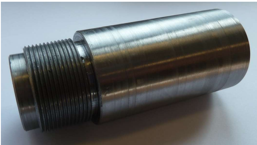
Abbildung 7-9: Gefertigter Adapter des neuen Werkzeugträgers
