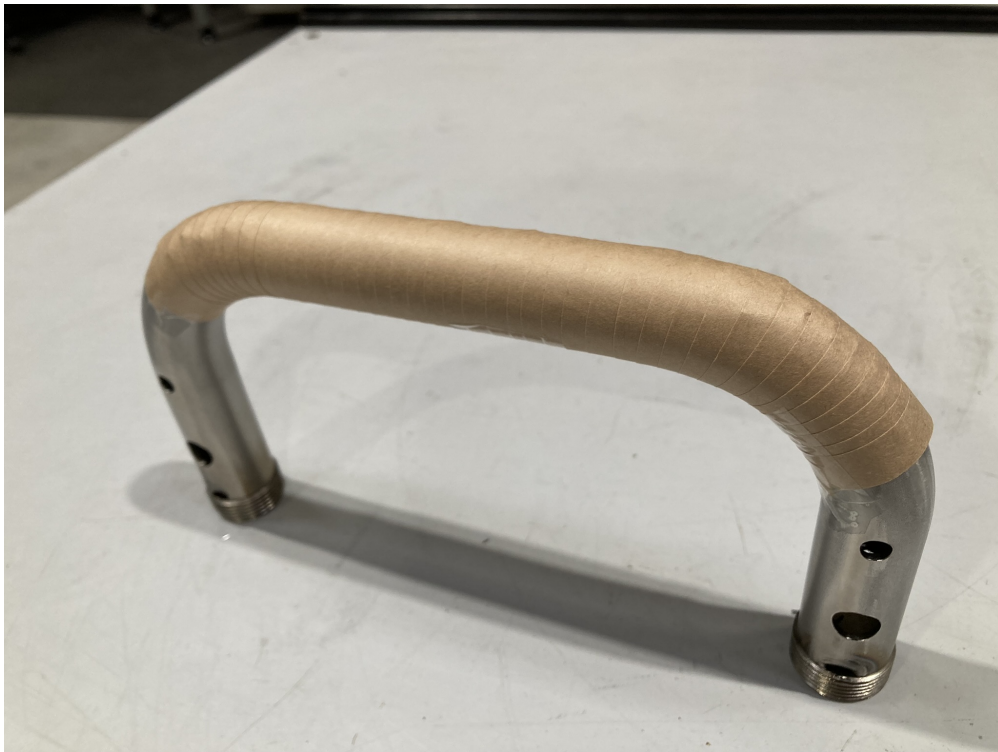
22 mm Leiterelektrode mit Kraftisolierpapier (KIP) umwickelt.
