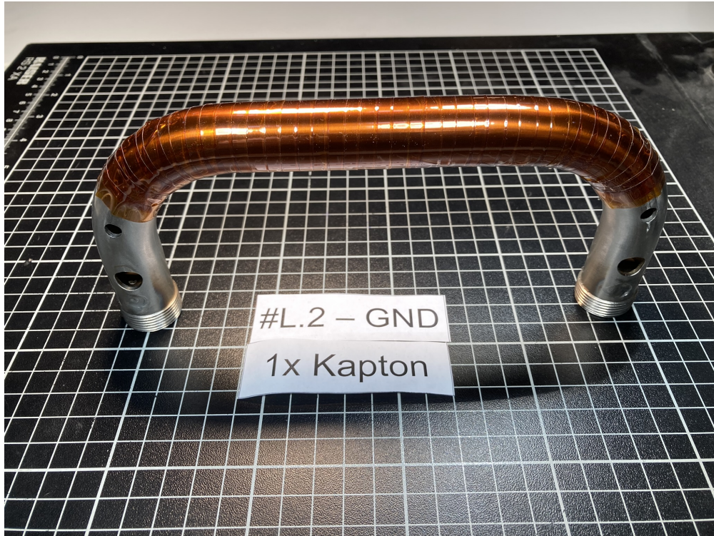
22 mm Leiterelektrode mit Polyimid (PI) umwickelt.
