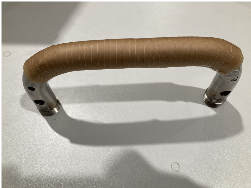
22 mm Leiterelektrode mit Polypropylen laminiertem Papier (PPLP) umwickelt.
