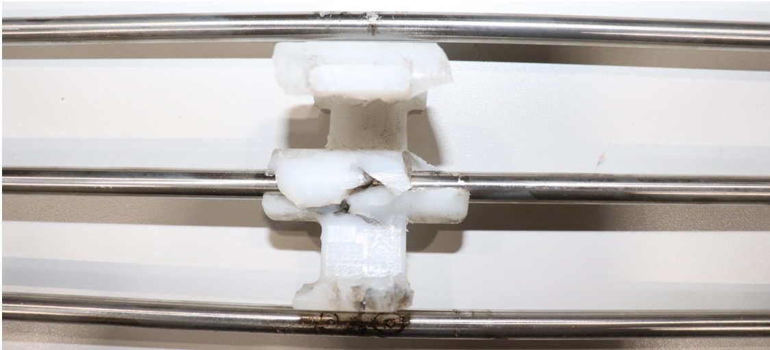
Abbildung 5.6: Fotografische Aufnahme des zerstörten Stützisolators nach den experimentellen Untersuchungen unter Wechsel- und Blitzstoßspannungsbeanspruchung.
