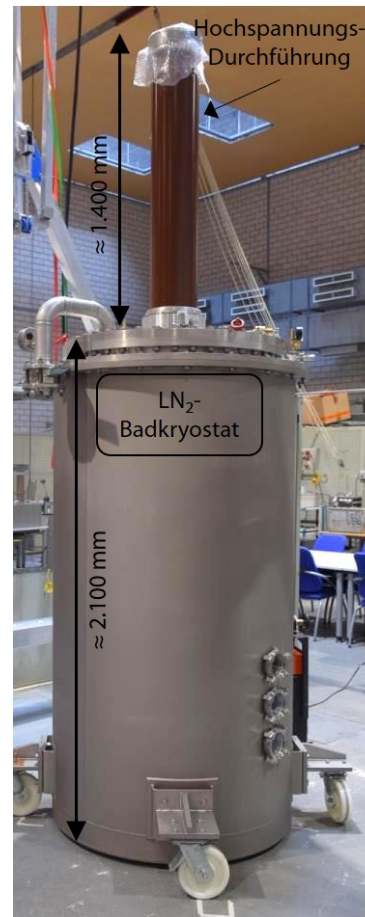
Abbildung 5.2: LN 2 -Badkryostat und Hochspannungsdurchführung.
