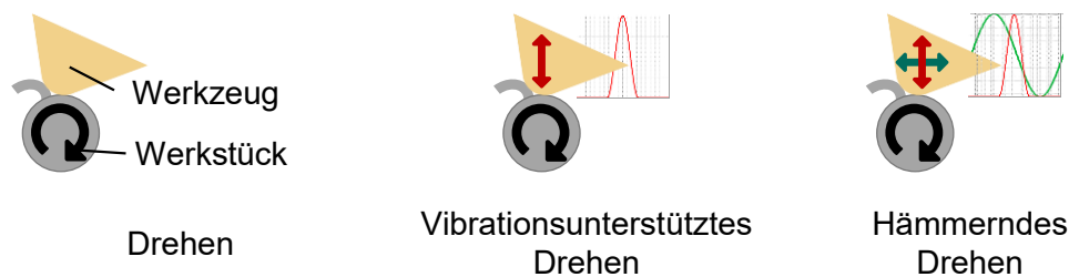
Abbildung 4-6: Kinematik des Werkzeugs für das "Hämmerndes Drehen", "Vibrationsunterstütztes Drehen" und "Drehen"
