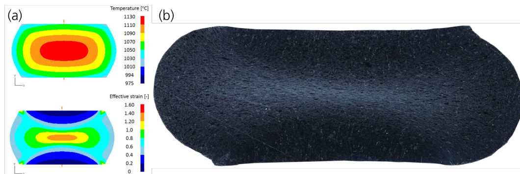
Abbildung 4.6: Korrelation zwischen Umformparametern und Kornstruktur in einem Stauchzylinder. a) Darstellung einer simulierten Temperatur- und Dehnungsverteilung in einer Zylinderstauchprobe [2]. b) Dunkelfeldaufnahme der Kornstruktur einer in diesem Vorhaben gestauchten Probe.
