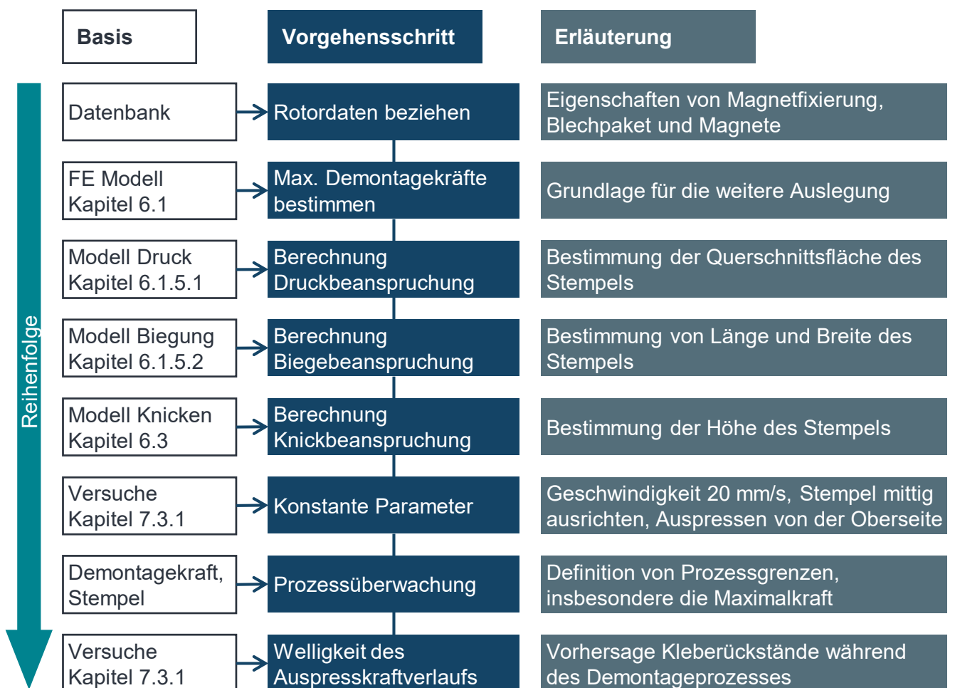
Abbildung 9-4: Vorgehensweise zur Prozessparametrierung bei der Magnetdemontage.
