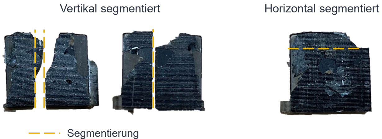
Abbildung 7-19: Magnetzustand nach der Demontage segmentierter Magnete.
