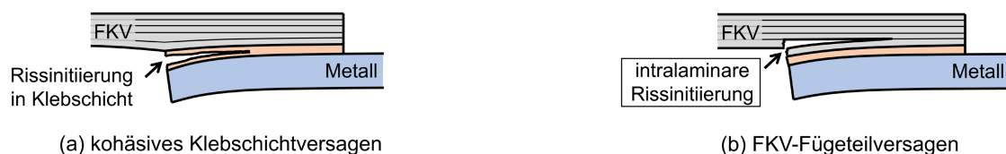
Abbildung 1.1: Skizze zweier möglicher Versagensmoden von FKV-Metall-Klebverbindungen; die Rissinitiierung erfolgt häufig am Überlappungsende aufgrund der hier wirkenden Spannungsspitzen
