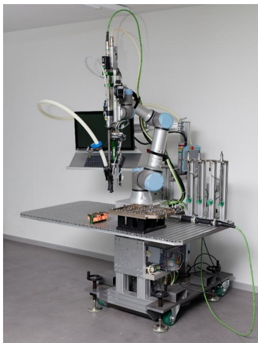
Abbildung 14: Aufbau des Demonstrators mit Kinematikeinheit (oben: Demonstrator-Arbeitsplatz, unten: Akku-Modell mit allen unterschiedlichen Verbindungselementen)
