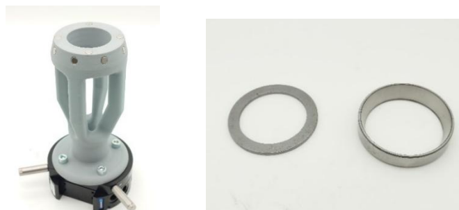
Abbildung 22: Magnetgreifer (links) zur Entnahme von Anlaufscheibe und Lagerschale (rechts)
