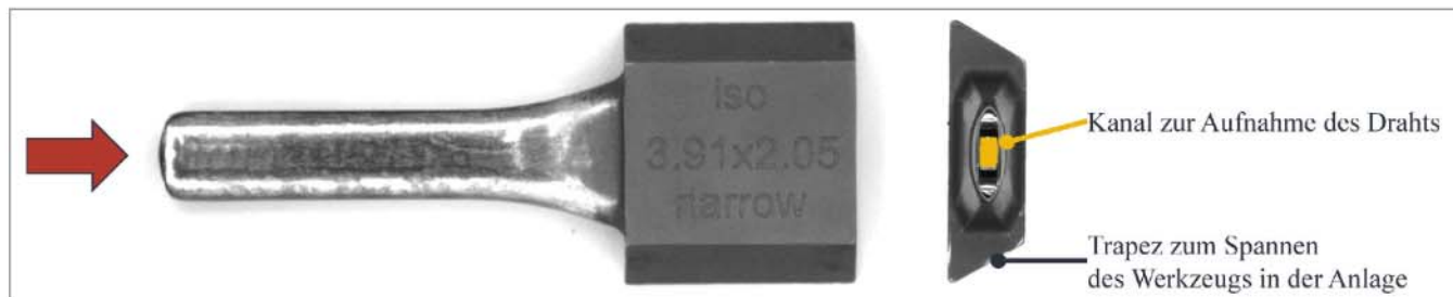
Bild 4 Twistwerkzeug zum sequentiellen Twisten eines einzelnen Hairpin-Drahtes. Das Drahtende wird aus Pfeilrichtung durch einen prismatischen Kanal im Werkzeug aufgenommen. Grafik: wbk
