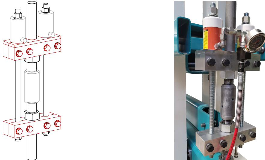
Abb. 3: Planung (links) und Ausführung (rechts) des Vorspannsystems
