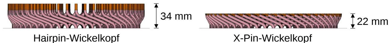
Abbildung 2-7: Beispiel einer theoretischen Gegenüberstellung der Kontaktierseite von Statoren mit klassischem Hairpin- und X-Pin-Wickelkopf
