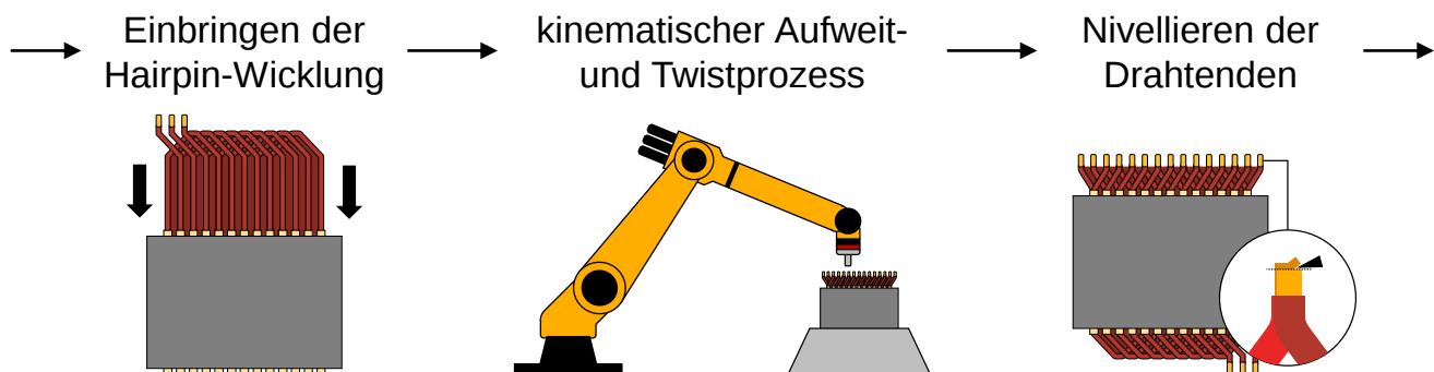
Abbildung 3-1: Eingliederung des im Rahmen der Forschungsarbeit angestrebten kinematischen Aufweit- und Twistprozesses in die übergeordnete Prozesskette zur Fertigung von Hairpin-Statoren
