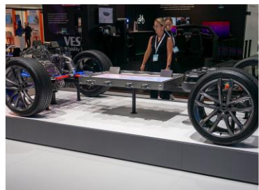
Abbildung A.25: Zwei der sechs untersuchten Systemgenerationen der BYD Traktionsbatterien. (Bildquellen:
