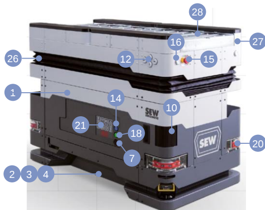
Abbildung A.32: Systemmodell für die Fallstudie SEW DTS anhand eines der G 2 ähnlichen Systems. Die Subsysteme 5, 6, 8, 9, 17, 24 sind nicht sichtbar. Die Subsysteme 11, 13, 19, 22, 23, 25 sind im dargestellten System nicht vorhanden (Bildzitat gem. § 51 UrhG zur inhaltlichen Analyse: SEW-EURODRIVE, 2024, https://www.sew-eurodrive.de/automatisierung/maxolution-systemloesungen/mobile-systeme/mobile-transportsysteme/mobile-transportsysteme.html ).
