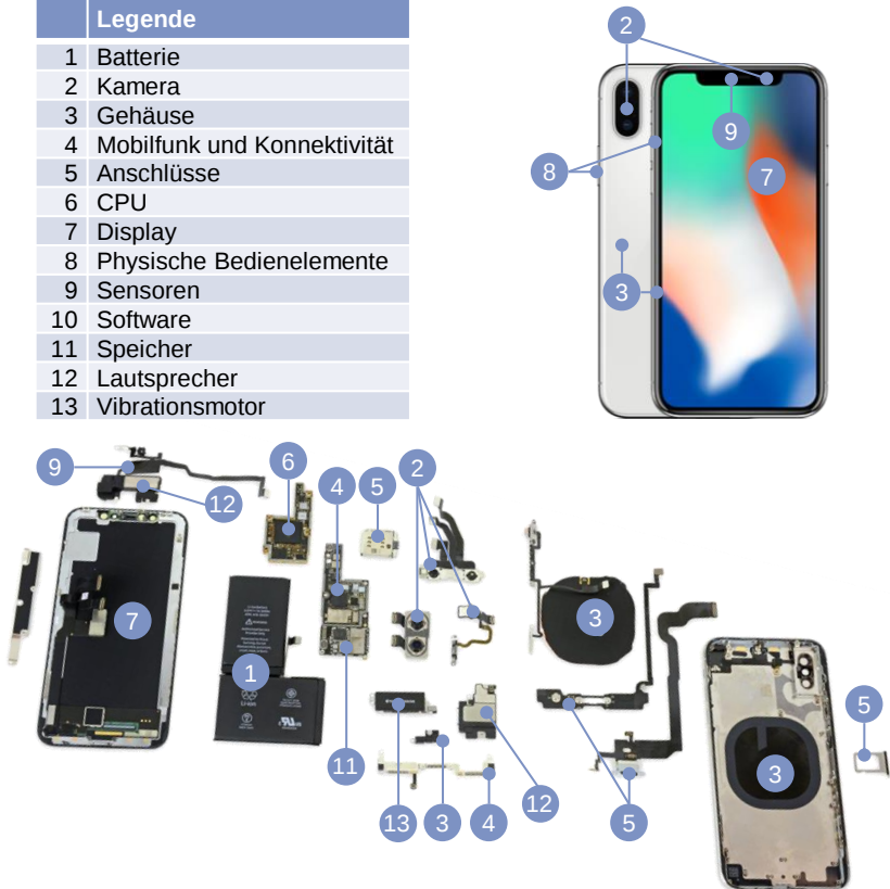
Abbildung 6.1: Systemmodell für die Fallstudie Apple iPhone anhand der G 11 iPhone, X (Goldheart, 2017, https://de.ifixit.com/Teardown/iPhone+X+Teardown/98975 , Lizenz der bearbeiteten Abbildung: CC BY-NC-SA 3.0, https://creativecommons.org/licenses/by-nc-sa/3.0/ ).
