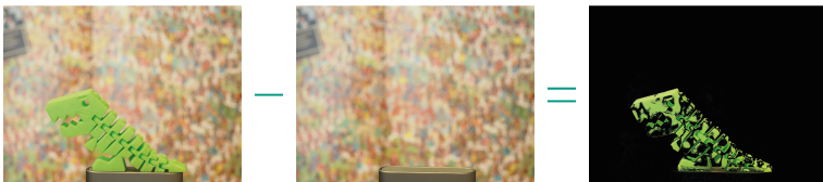
Abbildung 4.10: Beispiel einer Bildverarbeitung mit der referenzbildbasierten Differenzmethode zur Extraktion des Objektanteils
