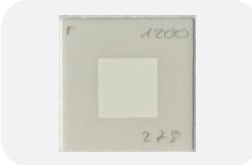
Abbildung 3.3: Ablauf der Probenpräparation der symmetrischen Zellen: Das Trägersubstrat besteht aus 8YSZ. Der erste Schritt besteht aus einem symmetrischen Druck einer GDC Schicht, jeweils auf Vorder- und Rückseite des Substrats, wobei die Schicht bei 70 °C für 24 h getrocknet wird. Danach folgt der Sinterprozess bei verschiedenen Sintertemperaturen. Modellzelle MZ-B und MZ-D werden nach dem Sinterprozess durch eine entsprechende Nitratlösung infiltriert, gefolgt von einem Trocknungsprozess bei 70 °C und Kalzinierungsprozess bei 400 °C. Abschließend wird die GDC Elektrode symmetrisch mit einer NiO- bzw. Au-Stromsammlerschicht versehen, welche erneut bei 70 °C getrocknet und während des Betriebs in Wasserstoffatmosphäre bei 800 °C reduziert und gesintert wird. Im unteren Teil der Abbildung befindet sich beispielhaft ein Foto der symmetrischen Zelle nach jedem Prozessschritt.
