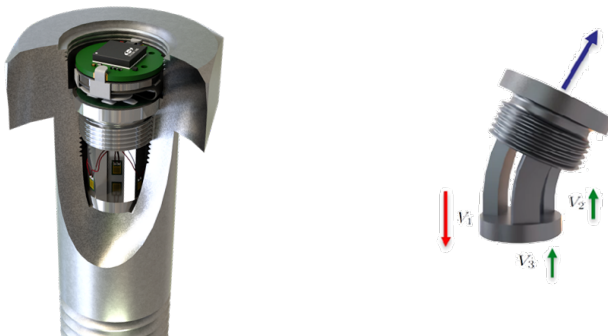
Abbildung 6.16: Iteration V3 mit sechs flachen DMS, die zu drei Halbbrücken verschaltet und jeweils auf einem Biegebalken angeordnet sind. Der Verformungskörper hat drei Biegebalken, die in 120° zueinander versetzt sind. Abbildung basierend auf Herbst et al. (2024).
