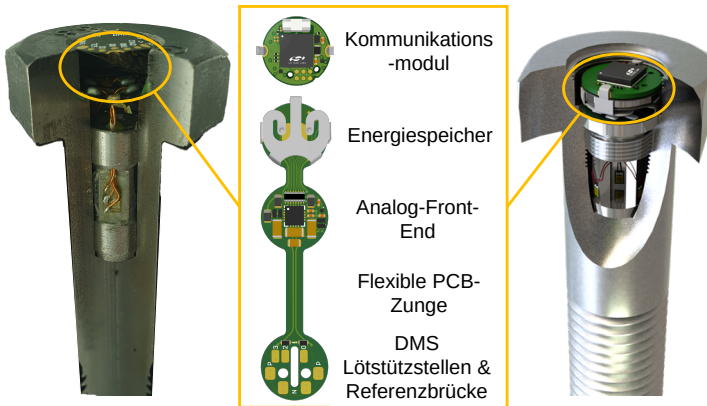
Abbildung 6.4: Miniaturisierte, flexible, modulare Elektronikplattform F 2 LECS zur Erfassung und drahtlosen Kommunikation von DMS-Signalen, die komplett in den Schraubenkopf integrierbar ist. Abbildung angelehnt an Riehl et al. (2024) und Peters et al. (2026).
