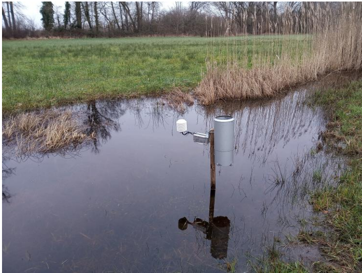
Abb. 3: Messstation mit Hellmann-Regenmesser, Temperatur- und Luftfeuchtesensor
