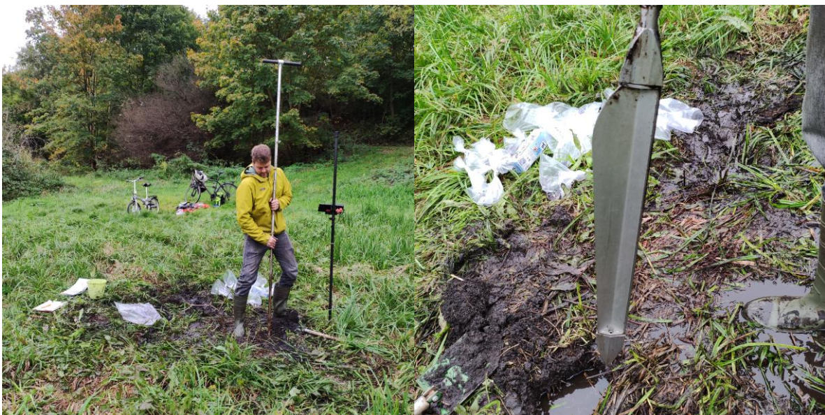
Abb. 7: Probennahme mit der Moorklappsonde (L. Pfaff an Moorklappsonde)
