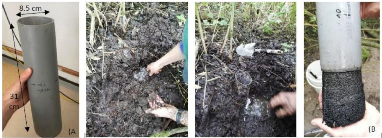
Abb. 29: Probenentnahme mit dem Stechzylinder (A), entfernen der 5 cm-Schicht, eingesenkter Stechzylinder und Entnahme der Probe aus dem Zylinder (Quelle: Gaudefroy 2024)
