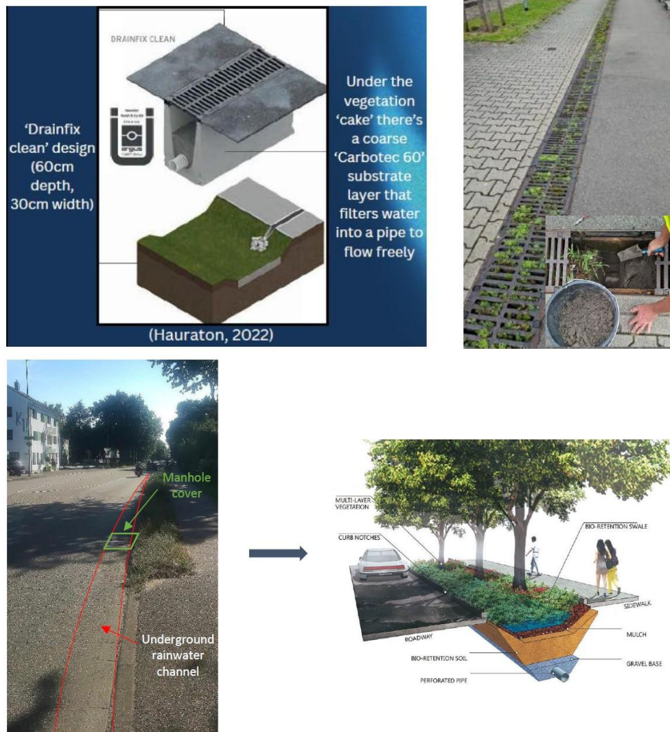
Abb. 34: Dezentrale Entwässerungs- und Wasserreinigungsmethoden (Institut für Wassergütwirtschaft, Dinic Brankovic M. et. al, 2018 in Gaudefroy 2024)
