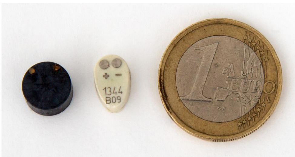
Abbildung 54 Vergleich der ersten Charge von Wyon-Zellen (links) mit einer der neuen Charge (Mitte) und einem Eurostück. Das Eurostück dient dem Vergleich der Größe der Zellen.
