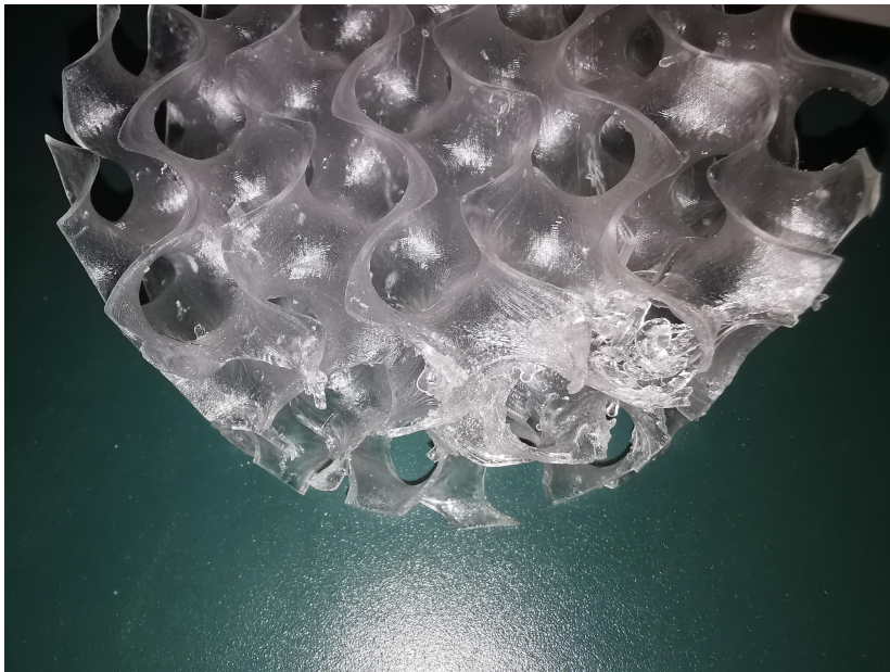
Abbildung B.5.: Fehlerhafter Druck mit Clear Resin mit Aufbrüchen an den Rändern.
