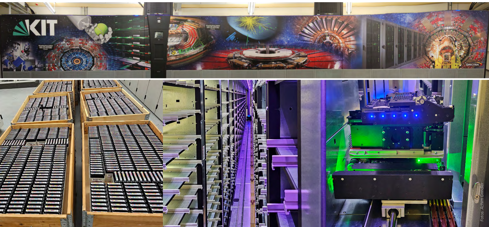
Abbildung 2: Panoramabild der gesamten Bandbibliothek (oben), Transportbox mit Bandkassetten (links unten), Blick ins Innere mit regalförmig angeordneten Aufnahmen für die Terapacks (unten Mitte), Blick auf einen der beiden Bandroboter (rechts unten)
