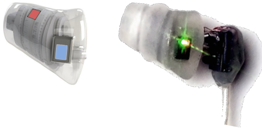
Abbildung 4.8: Integrierte aufblasbare Otoplastik für Druck- und PPG-Sensor, links: CAD Modell nach [RRJH21] (rot: Drucksensor, blau: PPG-Sensor), rechts: gefertigter Demonstrator
