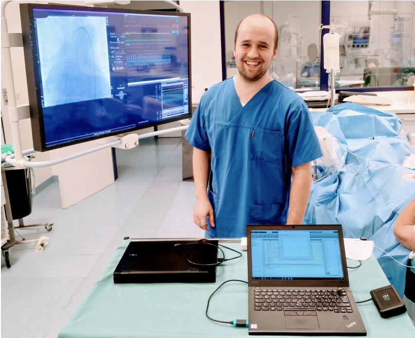
Abbildung 6.2: Messaufbau im Herzkatheterlabor, oben links ist der Monitor des Sensis Referenzsystems, in der mitte unten der Laptop zur Aufzeichnung der In-Ohr-System Messungen und rechts der Patient mit eingebrachter Sensorotoplastik zu sehen
