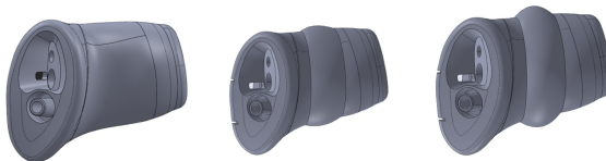
Abbildung 4.9: Otoplastik-Varianten ohne, mit geringer und mit starker Vorspannung [RRJH21]
