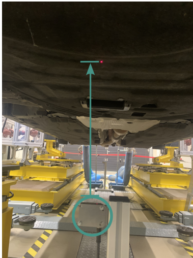
(a) Position des Sensors an der Vorderachse
