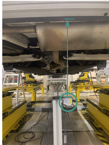
(b) Position des Sensors an der Hinterachse
