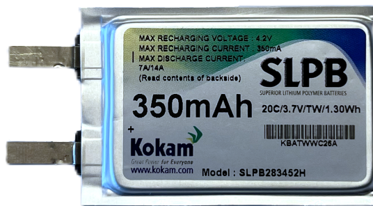
Abbildung 3.1.: Untersuchte kommerzielle Pouch-Zelle des Herstellers Kokam vom Typ SLPB283452H (Darstellung im Maßstab 1:1).
