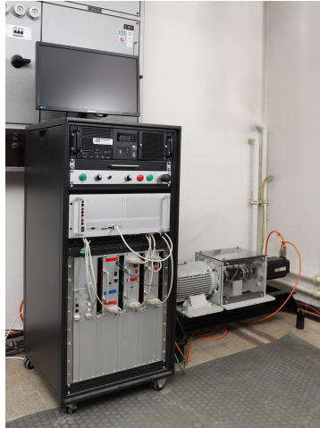
Abbildung 5.8: FESM-Prüfstand mit Leistungselektronik, Signalverarbeitung und Maschinenbett
