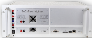
(a) SoC-Stromrichter mit Signalverarbeitung für Prüfling und Lastmaschine
