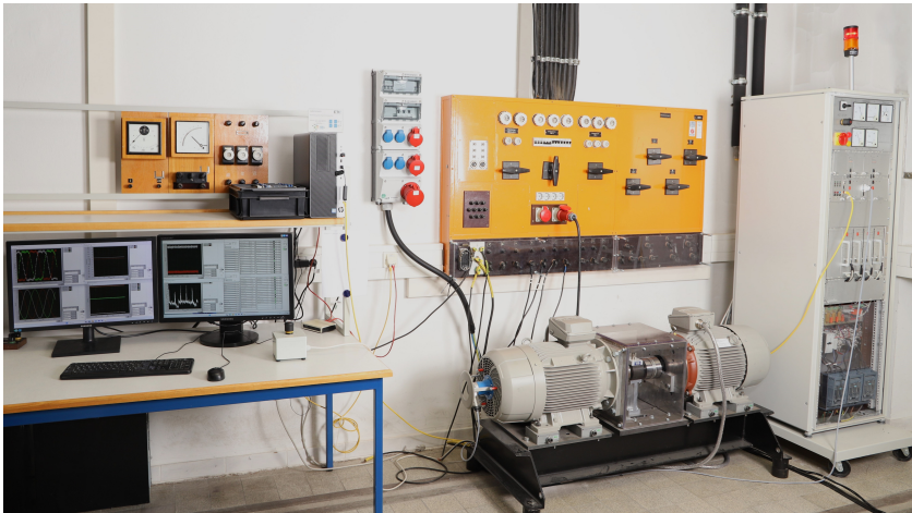
Abbildung 5.10: ASM-Prüfstand mit Leistungselektronik, Signalverarbeitung und Maschinenbett
