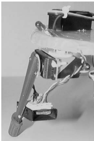
Abbildung 11: Ein Bein gesteuert durch zwei Servos mit angebrachtem Piezo-Sensor
