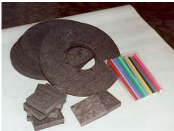
Abbildung 1.2: Brems scheiben aus CFC (links: für Flugzeuge, rechts: für Autos)
